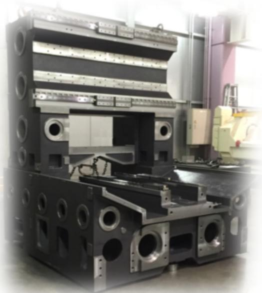
Assi controllati da motori lineari(X, Y & Z)
