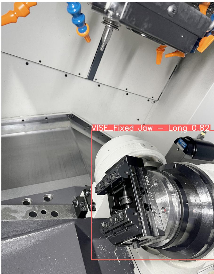
Riconoscimento di una morsa tramite machine vision presso il laboratorio PoliMill del Politecnico di Milano
