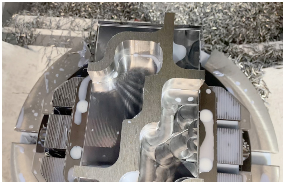
Figura 5: Pezzo fresato. A destra la strategia di sgrossatura tradizionale e a sinistra quella trocoidale
