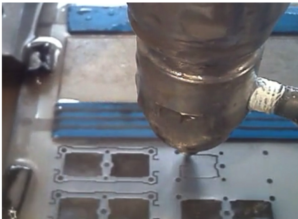
Figura 7. Metallo sinterizzato (acciaio magnetico), spessore = 1 mm, pressione dell'acqua = 340 MPa, abrasivo = Garnet #230, tolleranza del diametro del foro = \pm 0,006 mm (cortesia di WataJet s.r.l., Besnate (VA), Italia)
